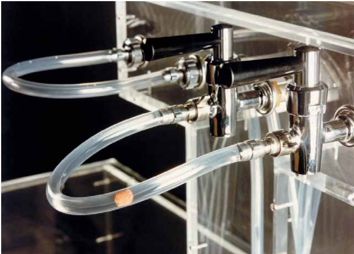
Automatische Reinigungssysteme besitzen den Vorteil einer kombinierten chemisch-mechanischen Reinigung.
